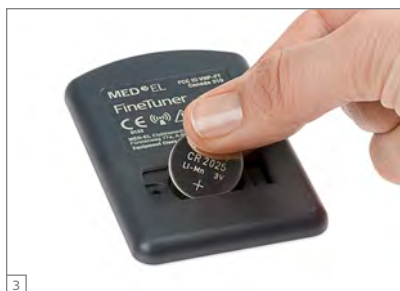
Sl. 23 Menjava baterij fine nastavitve
