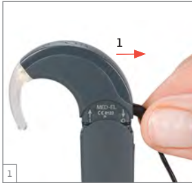
Sl. 14 Odklop kabla tuljave
