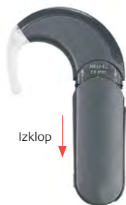
Sl. 3 Avdio procesor SONNET v izključenem položaju
