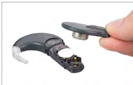
Sl. 22 Menjava baterij avdio procesorja
