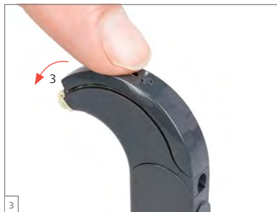
Sl. 20 Odstranjevanje in pritrjevanje prekritja mikrofona
