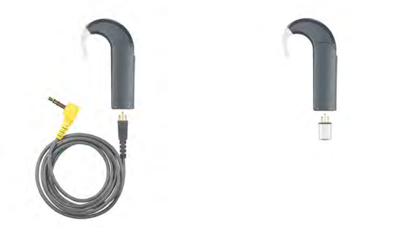
Sl. 21 Povezovanje prilagodilnega kabla in neposredno povezanih sistemov FM
