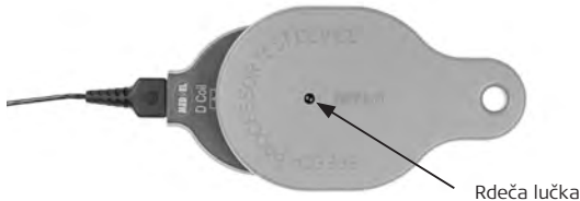
Sl. 24 Naprava za preizkušanje govornega procesorja
