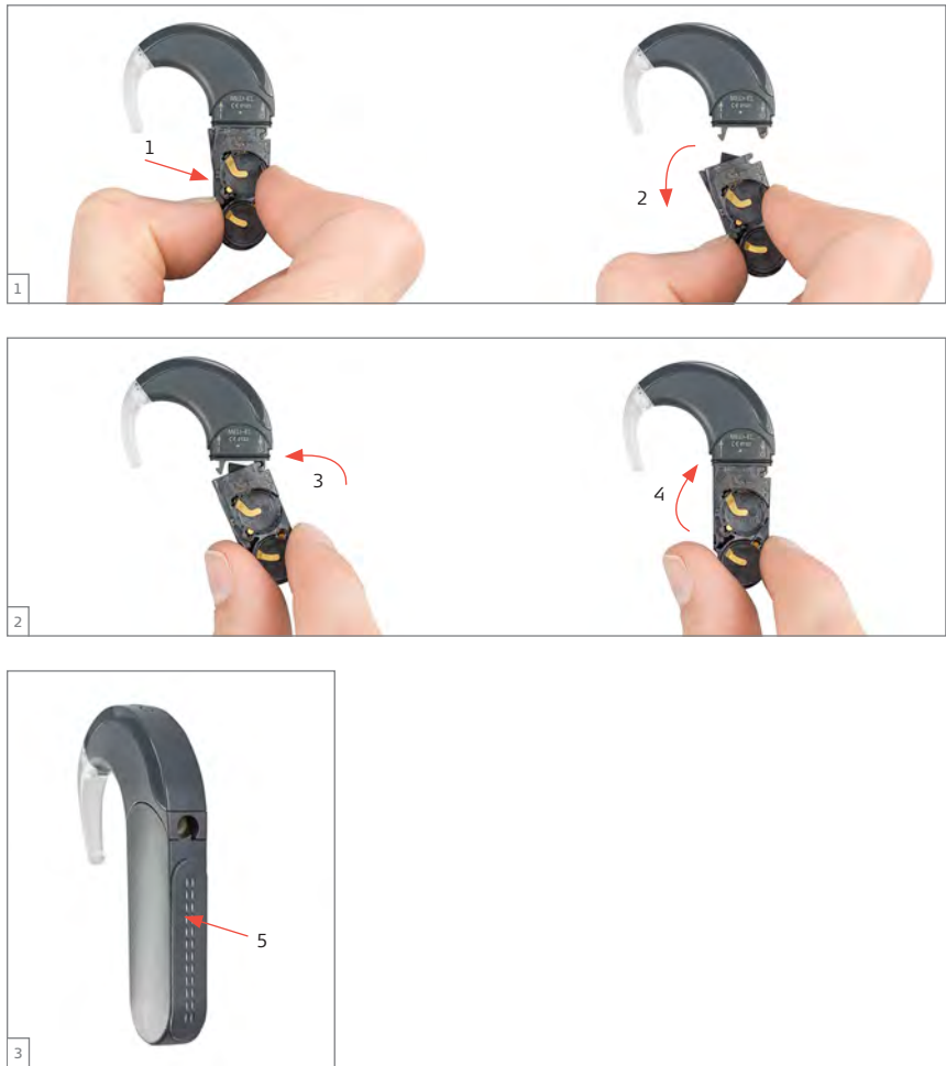
Sl. 8 Kako baterijski del odstranite/pritrдите z/na procesorski del
