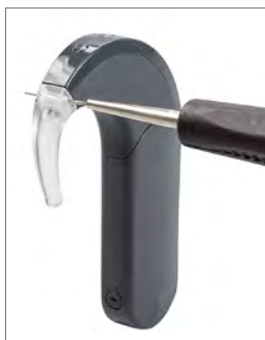
Sl. 17 Odstranjevanje zatiča zaušesne kljuge
