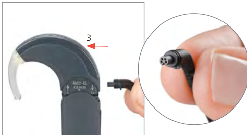
Sl. 15 Prikjučitev kabla tuljave v procesorski del
