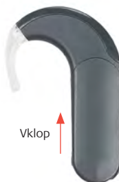
Sl. 4 Avdio procesor SONNET v vključenem položaju
