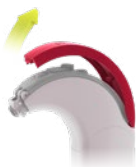
Slika 37 Odstranjevanje pokrova mikrofona
