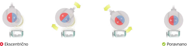
Slika 9 Poravnava magnetov tuljave in vsadka
