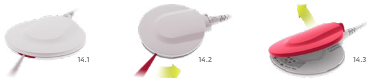
Sl. 14 odstranjevanje pokrova tuljave
